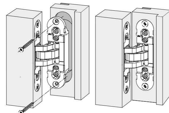
**ES - Monte la puerta sobre el pilar, introduciendo la parte marco de las bisagras (profundidad 21 mm) en las ranuras correspondientes, luego fíjelas enroscando los tornillos específicos.**
