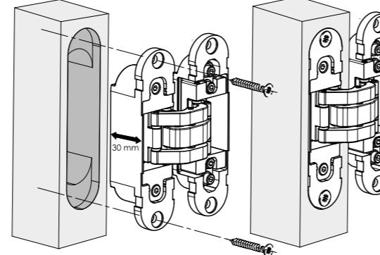
**IT** - Inserire la parte delle cerniere marchiata "door" (profondità 30 mm) nelle fessure dell'anta avendo cura di scegliere il corretto verso di apertura, fissare quindi le cerniere avvitando le appropriate viti da legno.
