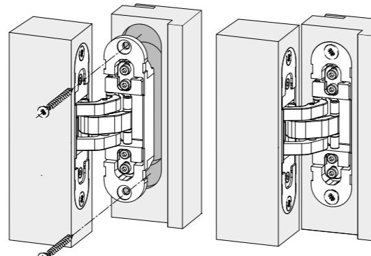
**IT** - Montare l'anta sullo stipite inserendo la parte telaio delle cerniere (profondità 21 mm) nelle apposite fessure, fissare quindi le cerniere avvitando le appropriate viti da legno.
